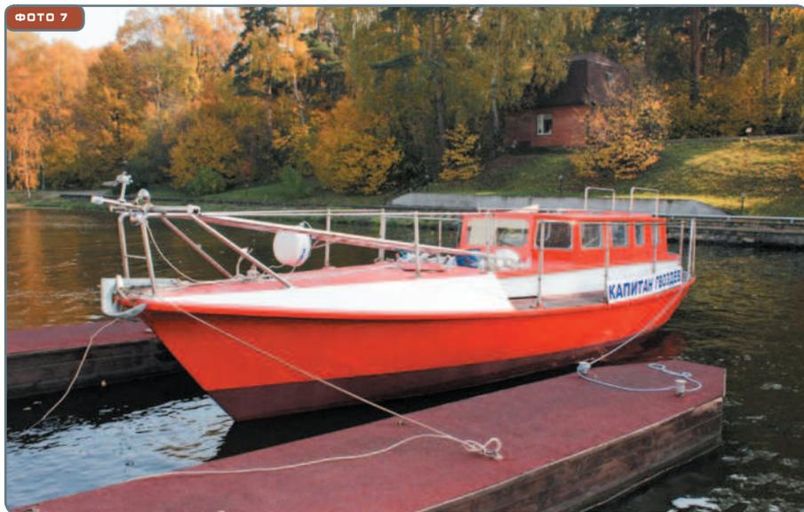
ЯХТА С КОРПУСОМ ИЗ МАЛОКЛИНКЕРНОГО НАНОЦЕМЕНТА 66 (ТОЛЩИНА СТЕНКИ БОРТОВ 12 ММ) НА КЛЯЗЬМИНСКОМ ВОДОХРАНИЛИЩЕ, 2009 Г.
