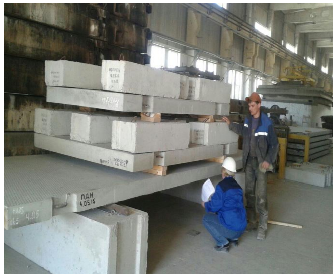
Фото 5 – проверка изделия ПДН на прочность Нагрузка – 7720 кг, прогиб составил 6 мм, при норме 30 мм. См: Отчет ИЛ ТОО «Стройдеталь» Исх: 112/11
