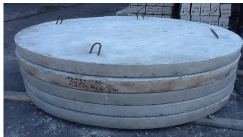
Фото 2 – крышка колодца КЦД 10
