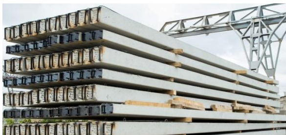
Фото 1 – опора ЛЭП – СВ92-2
